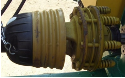
Рисунок 21а – Кардан с фрикционной муфтой.
