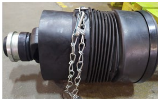
Рисунок 16.2 – Широкоугольный карданный вал с предохранительной и обгонными муфтами
